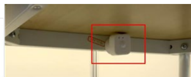
Bluetooth接続の人感センサーを各テーブル下に設置
